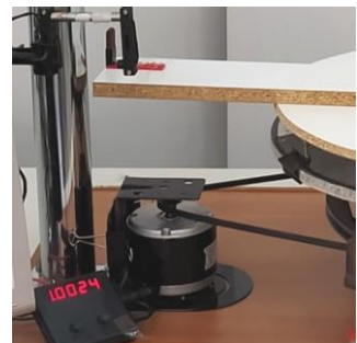
Εικόνα 3: Το μοτέρ, ο ιμάντας περιστροφής, η φωτοπύλη και το χρονόμετρο, ο πείρος.
